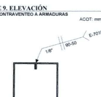
DETALLE. LARGUERO L2 CRITERIO PARA UNIR MONTANTES ESCALA: S/E ACOT: mm
