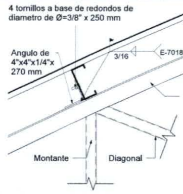
DETALLE 5. ELEVACIÓN APOYO DE LARGUERO EN ARMADURA ESCALA: S/E COT: mm
