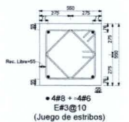
CORTE 1-1 PLANTA ARMADO DE DADO D1 ESCALA: S/E
