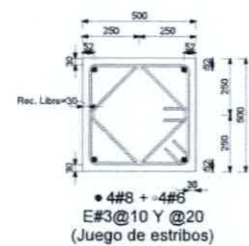
CORTE 2-2 PLANTA ARMADO DE COLUMNA C1 ESCALA: S/E
